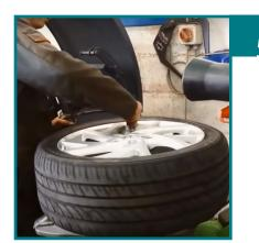
Установите покрышку обратно. Во избежание повреждения датчика не допускайте его соприкосновения с шиной. Теперь шину с датчиком TPMS можно накачать до нужного давления.
