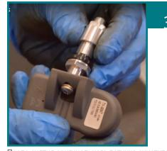
После снятия оригинального датчика очистите отверстие клапана от грязи. Запрограммируйте новый датчик (если имеется возможность, см. ЭТАП 2). После этого установите новый клапан и датчик в отверстие и закрепите его шайбой и гайкой. Затяните гайку с усилием 4 Н·м.
