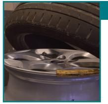
Установите колесо на поворотную площадку и снимите шину. После этого датчик можно снять.
