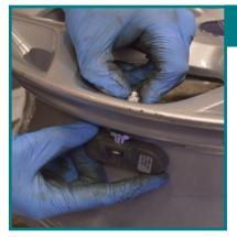
Установите корпус датчика с противоположной стороны от клапана. Вручную вверните крепежный винт и затяните его с усилием 2.2 Н·м.
