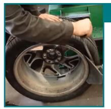
Извлеките ниппель и стравите воздух из шин. Установите колесо на станок для замены шин и разбортируйте его с обеих сторон. Датчик должен располагаться с противоположной стороны от места разбортировки.
